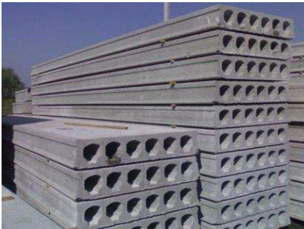
Рис. 60. Складирование железобетонных плит с круглыми пустотами
